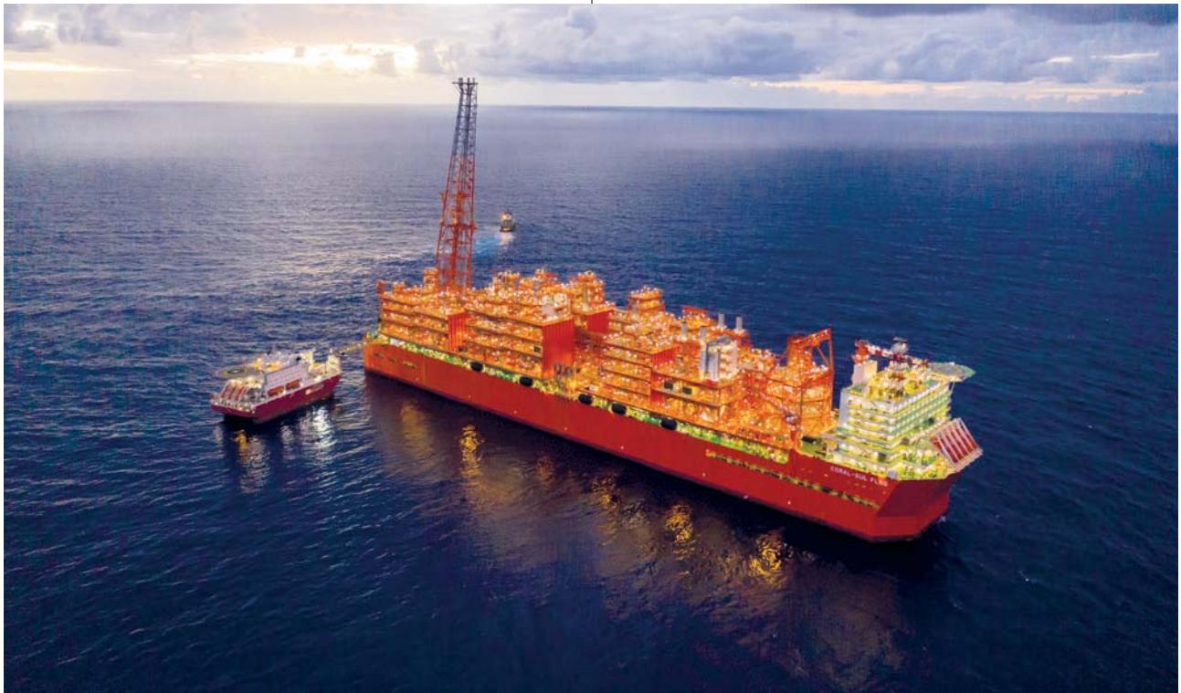
La Coral Sul FLNG è il primo impianto flottante di produzione, liquefazione ed export di LNG di nuova costruzione ad operare nel deep offshore africano
