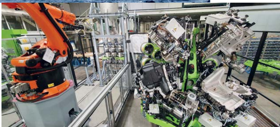
Automazione del processo rotazionale per la produzione di serbatoi destinati al settore automotive
